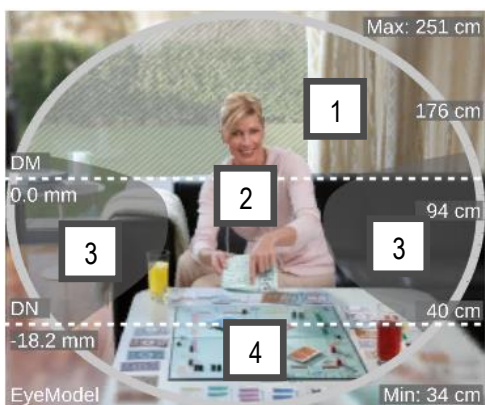
Фиг. 1: Схематична структура на стъкло за комфорт на разстояние. Замъглената зона не предлага ясно зрение
